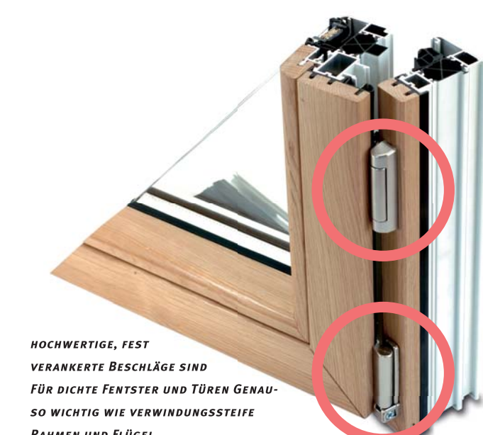
EINE AUSGEKLÜGELTE NUT/STECKVERBINDUNG MACHT SCHRAUBEN UND NÄGEL ÜBERFLÜSSIG. DAS SIEHT NICHT NUR SCHÖNER AUS, SONDERN VERHINDERT AUCH DAS AUFTRETEN PUNKTUELLER SPANNUNGEN IM HOLZ.
